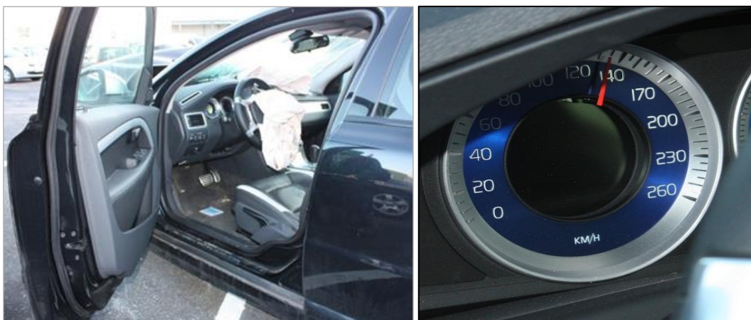
Bild på kupén i den påkörande bilen. Kupén var helt oskadad trots den höga kollisionshastigheten. Bilden till höger visar hastighetsmätaren som fastnat på 135 km/h. Foto: Eva Liljegren.
