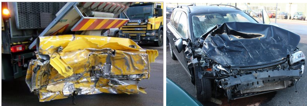
Påkört TMA-skydd och bild på den påkörande bilens front. Foto: Svevia respektive Eva Liljegren.
