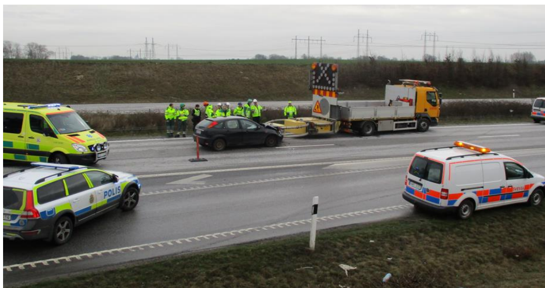
Trafikolycka där en personbil har kört in i ett TMA-skydd. Foto: Svevia
