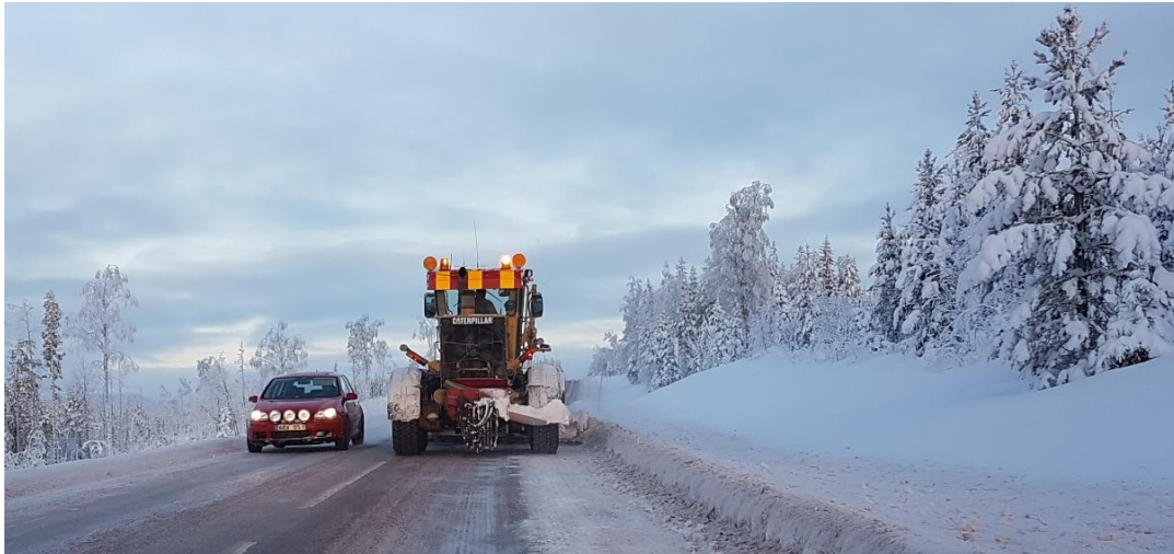
Väghyvel som utför vinterväghållningsarbete på en statlig väg. Foto: Eva Liljegen.
